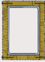
Izolare pe 4 laturi
