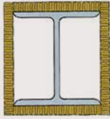
Izolare pe 4 laturi
