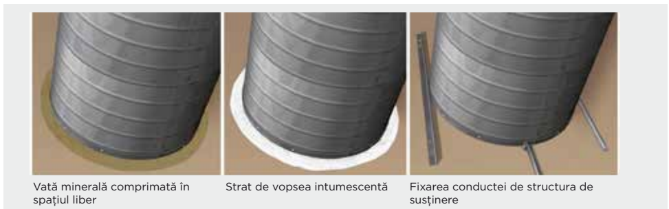
Fig. A.2.3: Etanșarea găurii de trecere prin podea.
