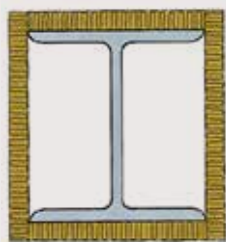
Izolare pe 4 laturi
